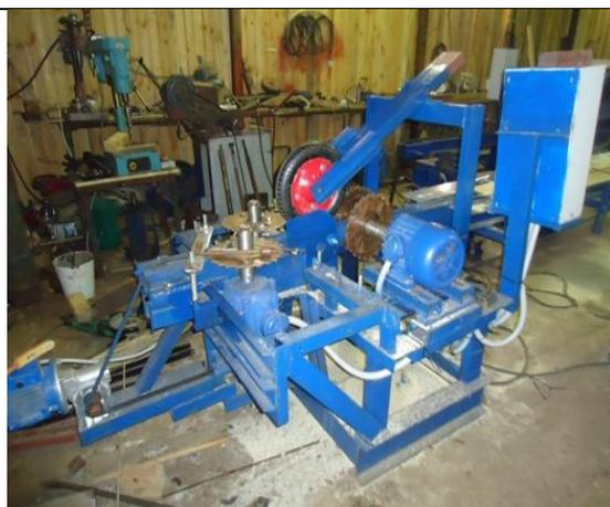
**НАЗНАЧЕНИЕ** – переработка необрезной доски (обрезание кромки) и переработка горбыля (обрезание кромки и снятие шапки горбыля).
