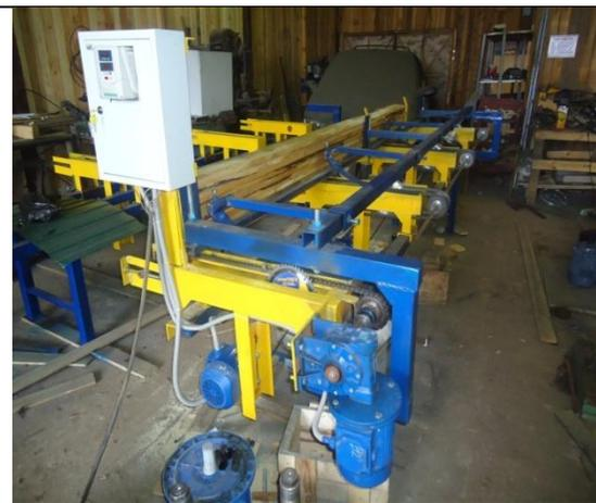
**НАЗНАЧЕНИЕ** – торцевание заготовки длиной до 3000мм несколькими пилами в паллетную заготовку заданной длины.
