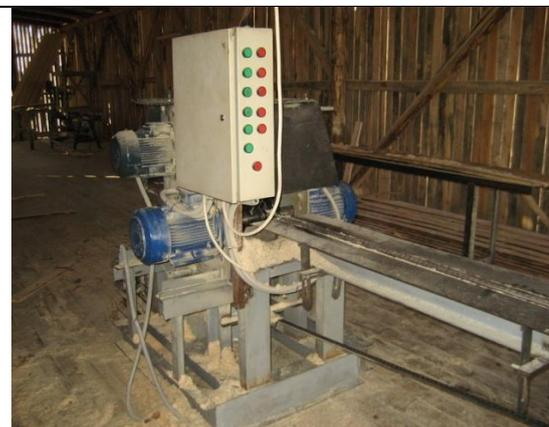
**НАЗНАЧЕНИЕ** – распиловка тонкомера на лафет (двукантный брус) и горбыль.
