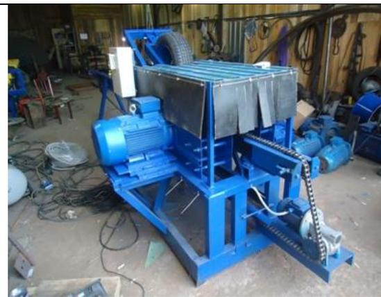
**НАЗНАЧЕНИЕ** – распиловка тонкомера (пиловочника) на лафет (двукантный брус), боковые доски и горбыль.
